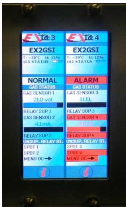
**Fig. 11: scheda EX2GSI in stato di allarme**
