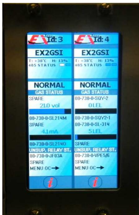
Fig. 9: scheda EX2GSI in stato normale
