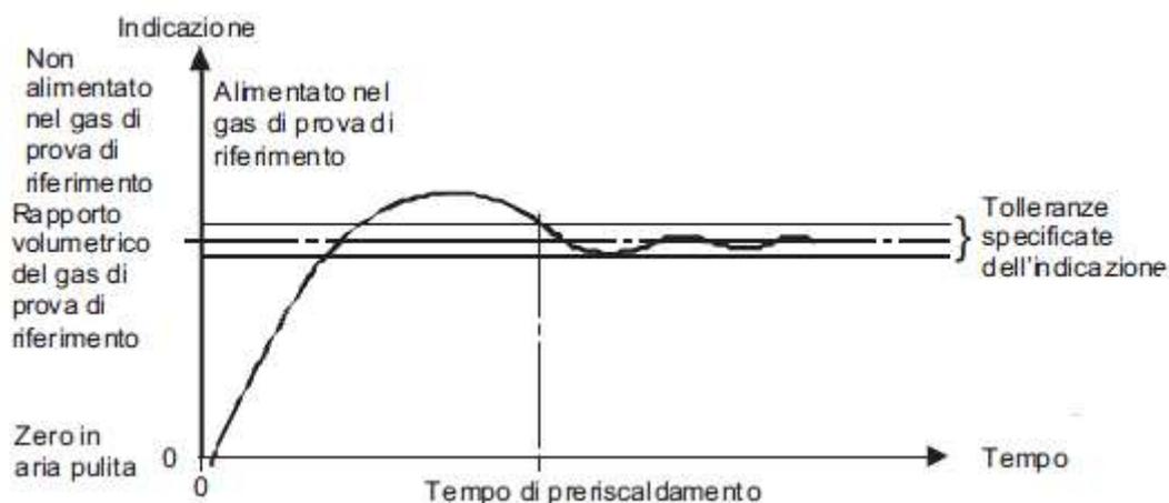
Fig.2: Tempo di preriscaldamento nel gas di prova di riferimento (tratto da EN 60079-29-1)
