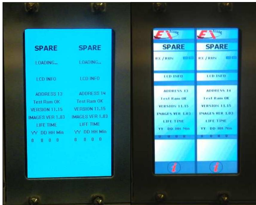
**Fig. 8: scheda EX2GSI in fase di inizializzazione (in progressione temporale da sinistra a destra)**
